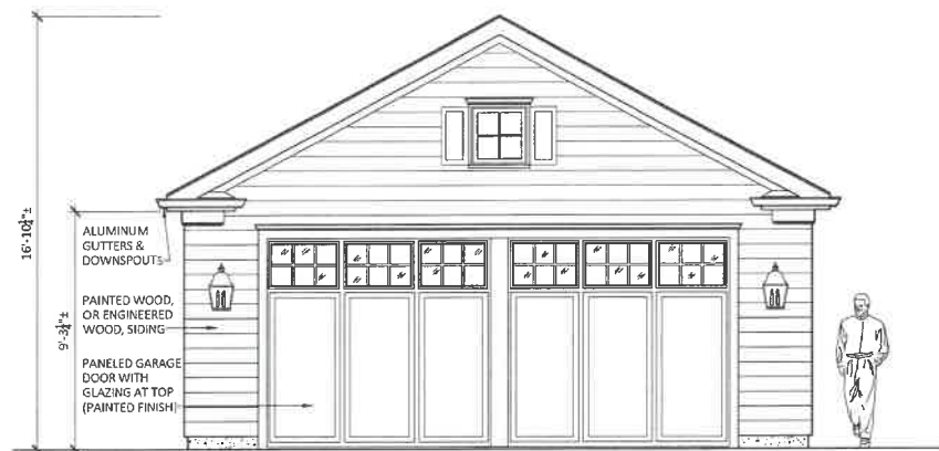
2 WEST ELEVATION Scale: 1/8"=1'-0"
